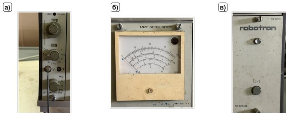
Рисунок А.4 – Функціональні блоки комплексу Robotron: а – інтегруючий підсилювач 00028; б – блок індикації 02022; в – блок живлення 04003
