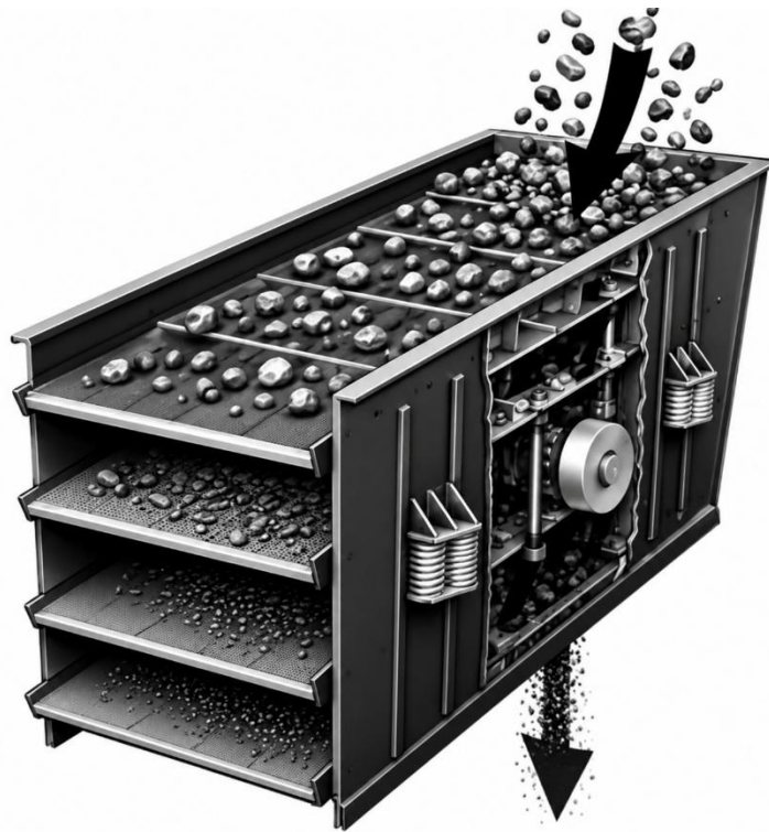
Рисунок 1.3 – Загальна схема роботи вібраційного грохота
